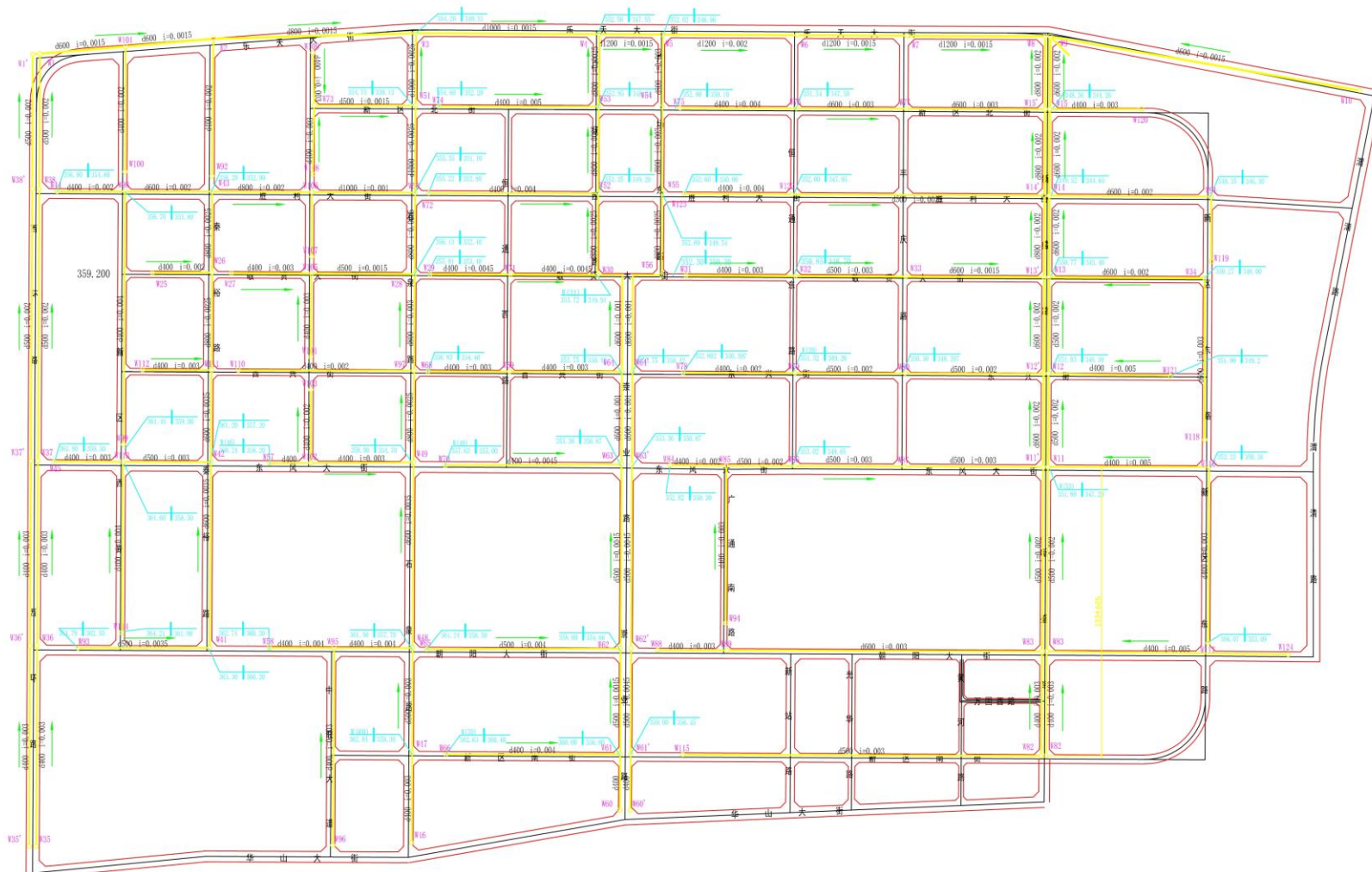
规划污水管道平面图 1:10000
